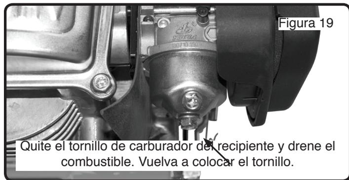
Quite el tornillo de carburador del recipiente y drene el combustible. Vuelva a colocar el tornillo.
